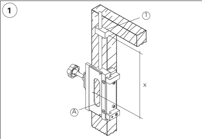
1. Posizionare la dima sul telaio. Misurare dall'interno della battuta al segno "A" l'altezza desiderata per il posizionamento della cerniera superiore.
