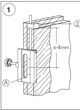
1. Posizionare la dima sull'anta. Fissare la distanza tra il punto interno della battuta e il segno "A" pari a X-4mm (X=altezza cerniera sul telaio).
