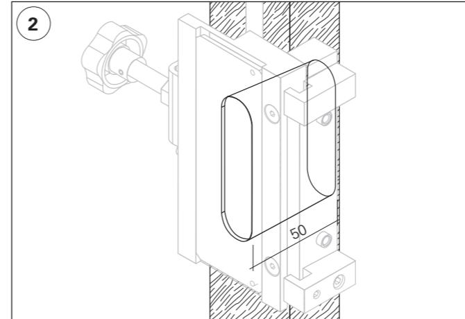
2. Effettuare la fresatura con una punta da Ø 20mm per una profondità di 50mm nel telaio.
