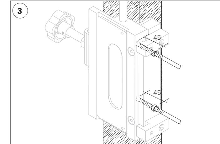
3. Eseguire i 2 fori laterali con una punta da Ø 6mm per una profondità di 45mm nel telaio.
