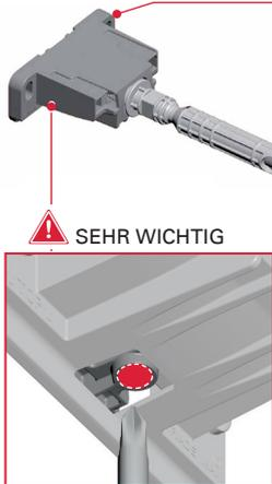
Feststellschraube um die Verstellmöglichkeit zu sichern
