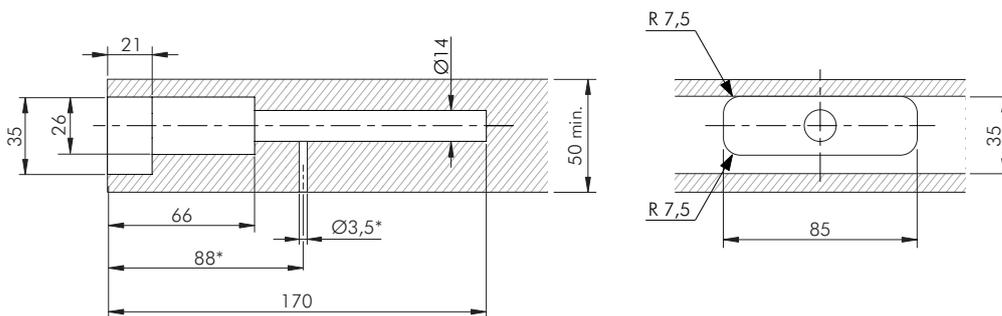
\* Optionale Bohrung für die Sicherheitsverriegelung mit M4-Gewindestift
